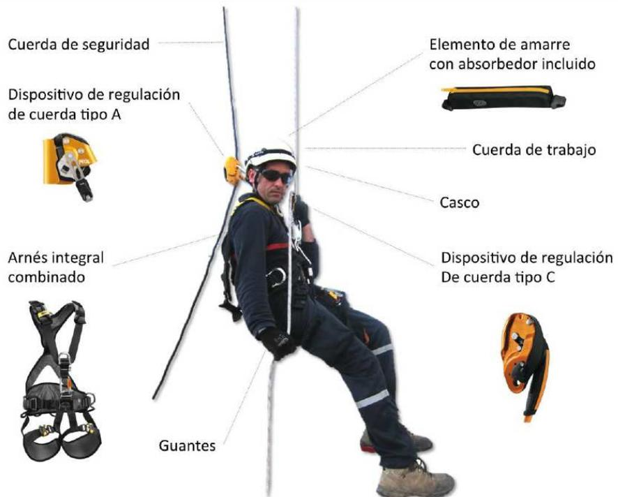
Ilustración 30: distintos elementos y componentes que configuran el sistema de acceso mediante cuerda.
