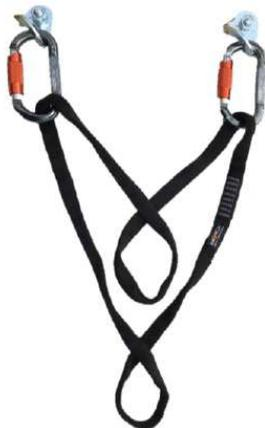
Ilustración 12: anclaje con repartidor, UNE-EN 795 tipo B, 2 vueltas siempre en el mismo sentido
