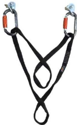
Ilustración 3: anclaje con repartidor, UNE-EN 795 tipo B, 2 vueltas siempre en el mismo sentido
