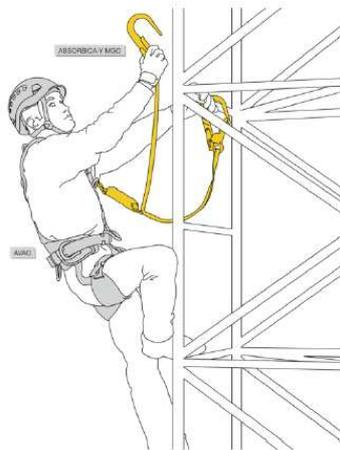
Ilustración 23: sistema anticaídas con Absorbica-Y MGO, fuente PETZL.
