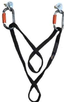
Ilustración 31: anclaje con repartidor, UNE-EN 795 tipo B, 2 vueltas siempre en el mismo sentido
