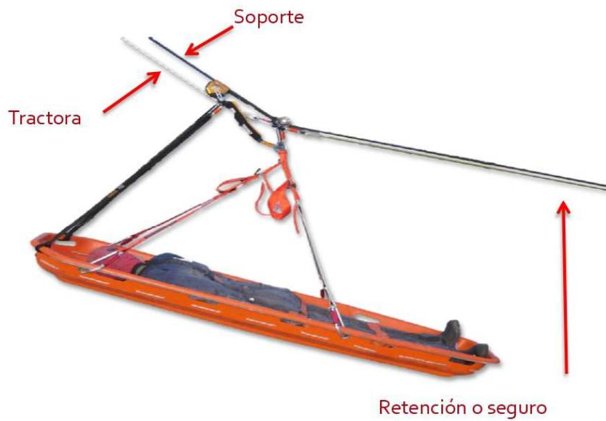
Ilustración 40: simulacro de salvamento, configuración de elementos en tirolina.
