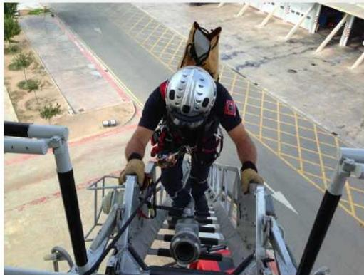
Ilustración 15: sistema anticaídas en AEA.
