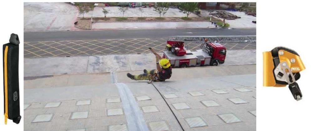
Ilustración 24: sistema anticaídas con Absorbica y ASAP LOCK.
