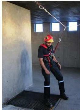
Los anclajes de una línea de seguridad sufren gran sollicitación de cargas, pueden superar incluso los 10 kN en ausencia de absorbedor. La utilización del absorbedor de energía permite limitar los esfuerzos sobre el sistema, es decir sobre usuario y anclaje.
