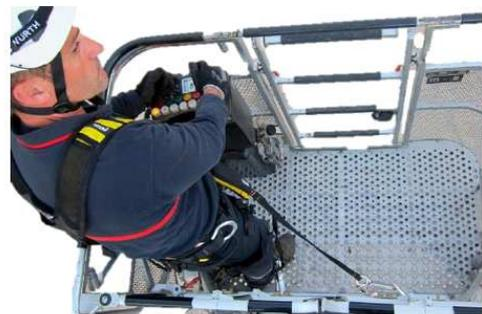
Ilustración 4: ejemplo de retención con andaje puntual, con elemento de amarre en simple a anclaje químico y anclaje a cesta en vehículo de altura.
